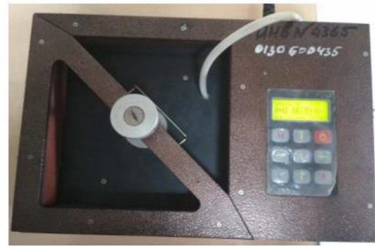
2-rasm. 15 x 15 x 2 sm o'lchamli ko'pikbeton namunasini issiqlik o'tkazuvchanlik ko'rsatkichini aniqlash jarayoni.
