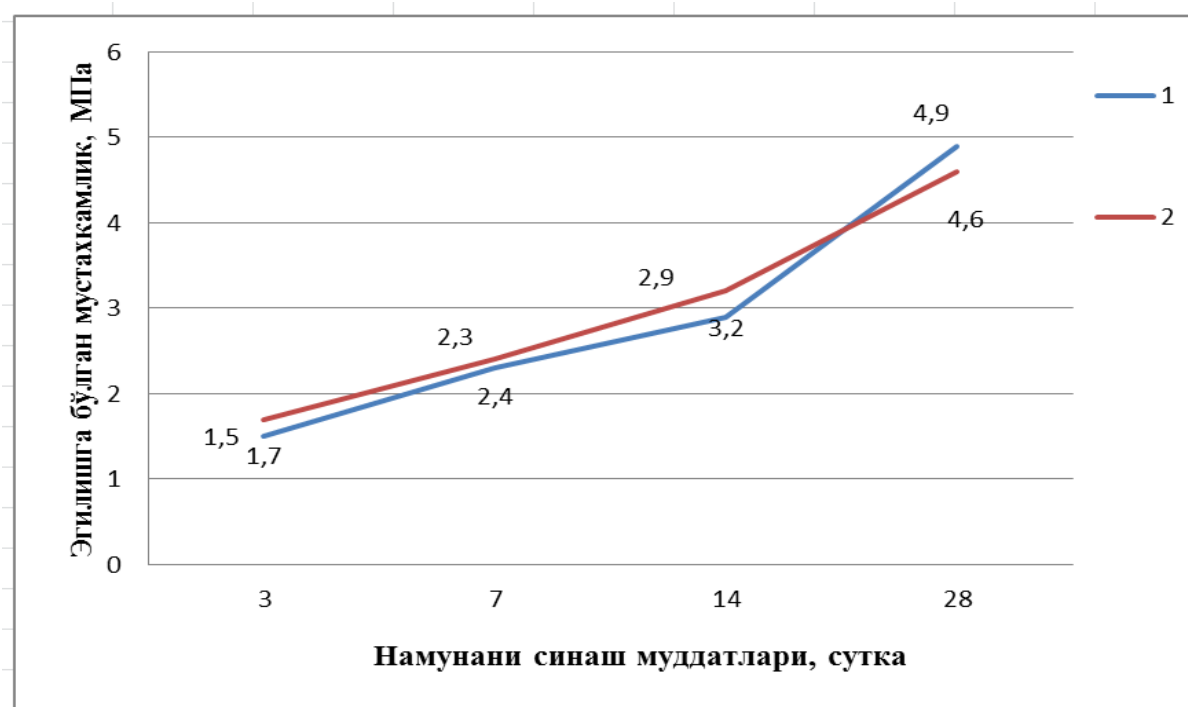
Расм 2. BETON MIX-07 қўшимчасини бетоннинг эгилишга бўлган мустахкамлигига таъсири.
