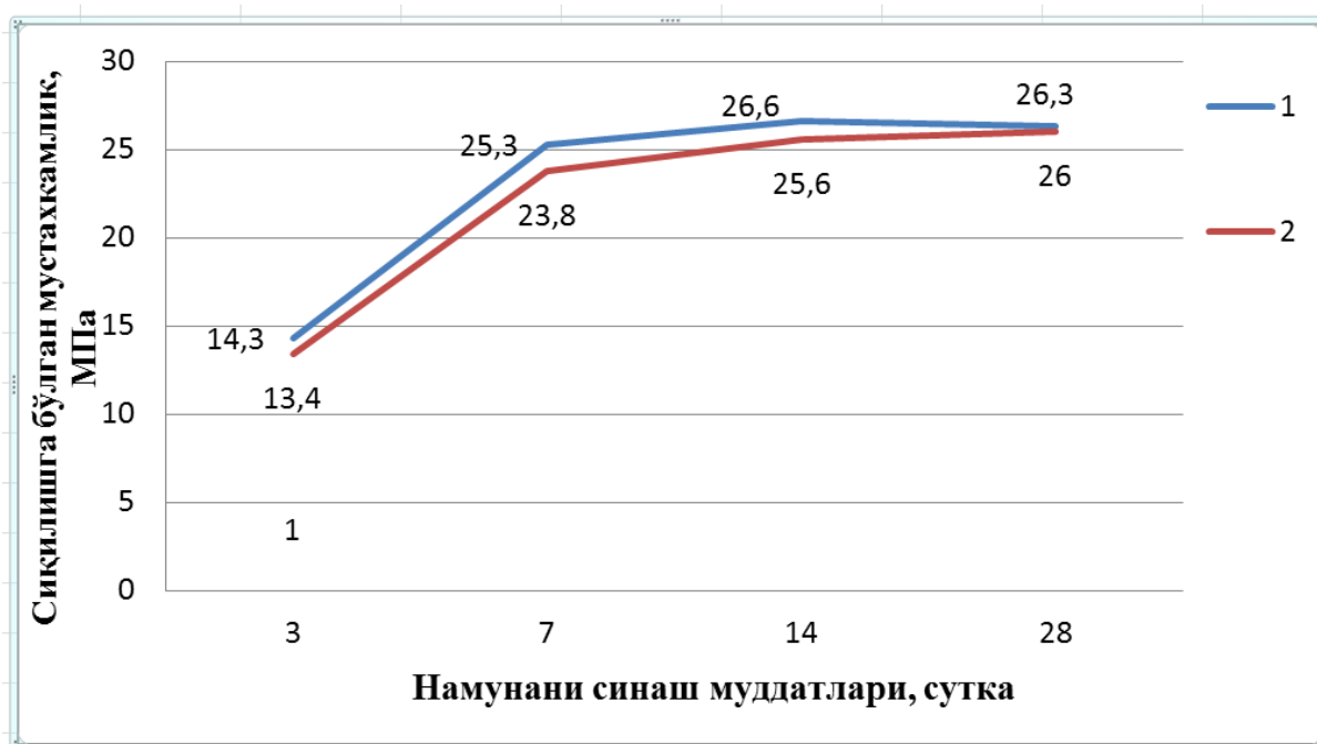
Расм 1. BETON MIX-07 қўшимчасини бетоннинг сиқилишга бўлган мустахкамлигига таъсири.
