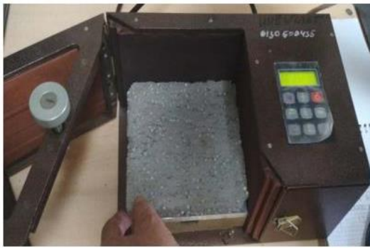
2-rasm. 15 x 15 x 2 sm o'lchamli ko'pikbeton namunasini issiqlik o'tkazuvchanlik ko'rsatkichini aniqlash jarayoni.
