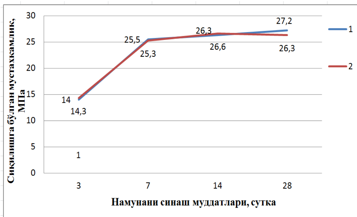
Расм 3. ВЕТОН MIX-07 қўшимчасини бетоннинг сиқилишга бўлган мустаҳкамлигига таъсири.
