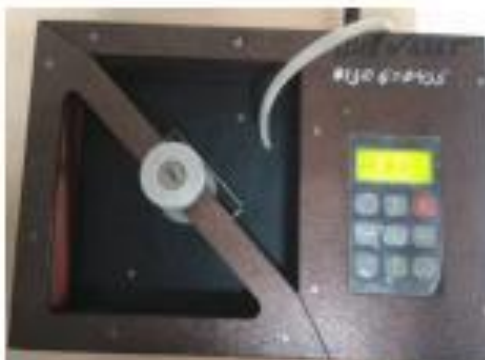
2-rasm. 15 x 15 x 2 sm o'lchamli ko'pikbeton namunasini issiqlik o'tkazuvchanlik ko'rsatkichini aniqlash jarayoni
