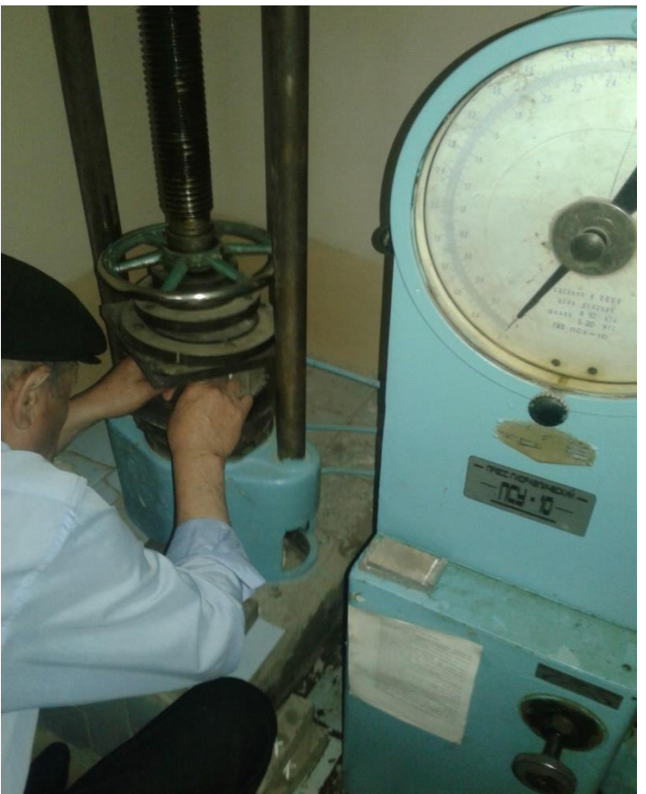
4. Намуналарни гидравлик прессда синаш.
