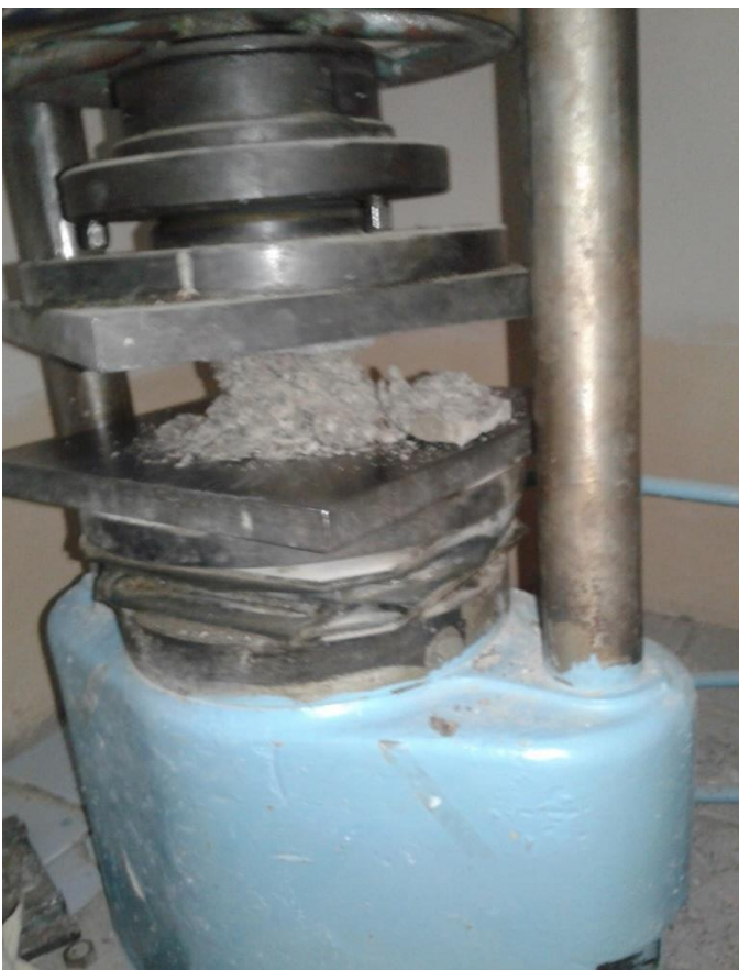
4. Намуналарни гидравлик прессда синаш.
