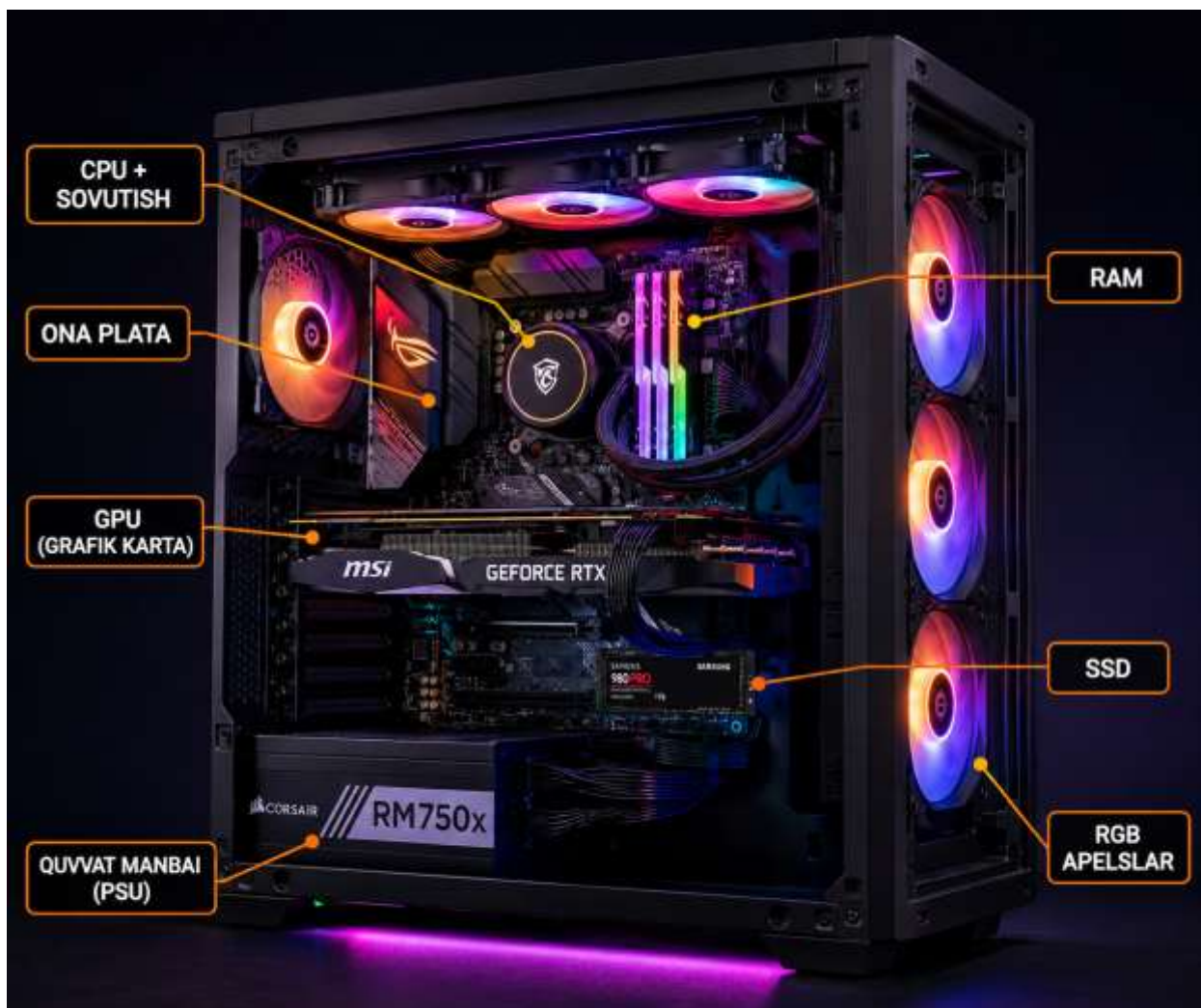
4.2b-rasm. Shaxsiy kompyuter ichki komponentlari
