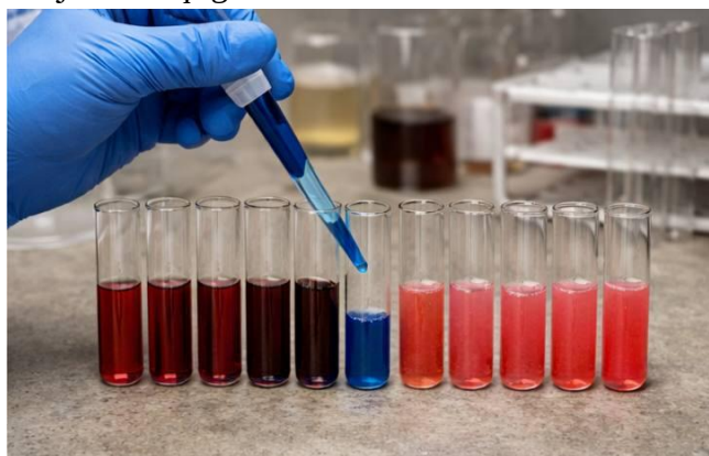
2-rasm. Fenol birikmalarni aniqlash jarayoni: pomidor ekstraktiga Folin–Ciocalteu reaktivi qo‘shilib, turli konsentratsiyalarda rangli kompleks hosil bo‘lishi (reaksiya natijasida rang o‘zgarishi).
