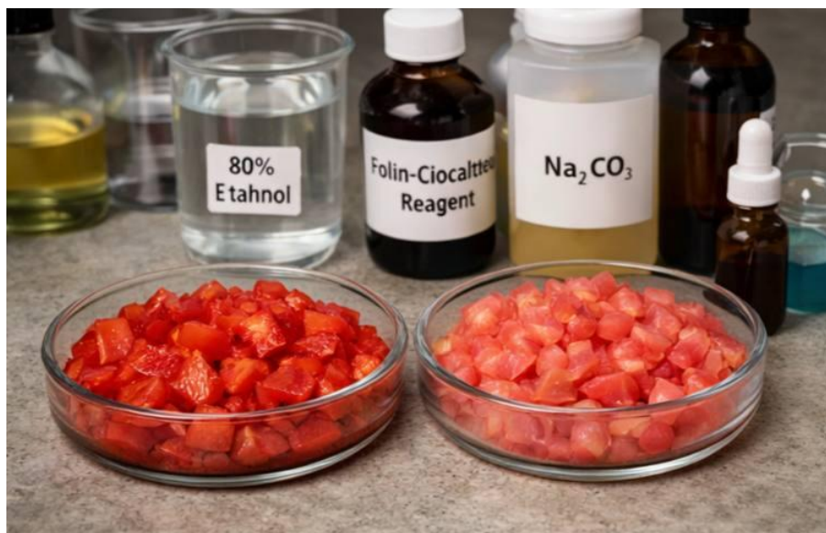
1-rasm. Qizil va pushti pomidor namunalarini tayyorlash jarayoni: maydalangan pomidor massasi hamda fenol moddalarni ekstraksiya qilishda qo‘llanilgan 80% etanol, Folin–Ciocalteu reaktivi va natriy karbonat eritmalari.
