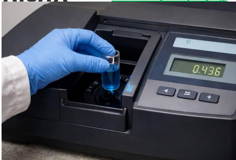
4-rasm. Spektrofotometr yordamida fenol moddalar miqdorini aniqlash jarayoni: namunaning optik zichligini 760 nm to'liq uzunligida o'lchash.
